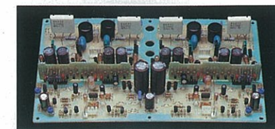
信号系路を最短距離にレイアウトしたシンメトリカルな新開発ディスパシナル基板。
