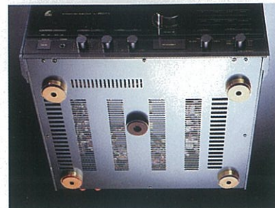
重心部に適度なコンプライアンスをもたせ、シャーシ、底板を同時にホルドしたCF5インシュレーター。
