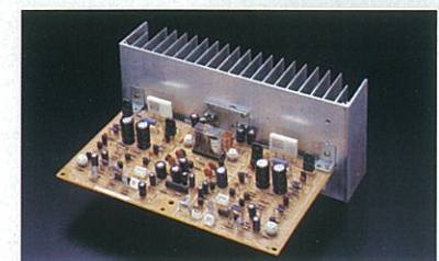
余裕の出力を再現するパワーアンプ部と大型ヒートシンカー。
