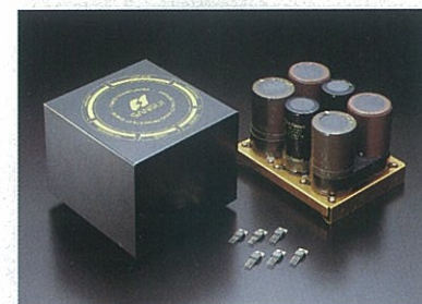
防振対策を施した超重量級大型ワートランスと、振動を防止するため銅メッキ鋼板にとりつけ、上部に防振ゴムを装着した大容量電源コンデンサー。
